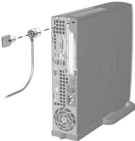
**Figura C-1** Installazione della chiusura con cavo
