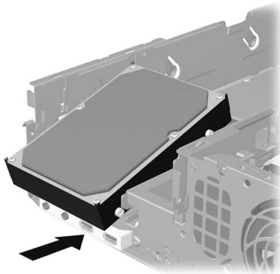
Bild 2-27 Installera en enhet i 3,5-tumsenhetsplatsen (bilden visar en hårddisk)
