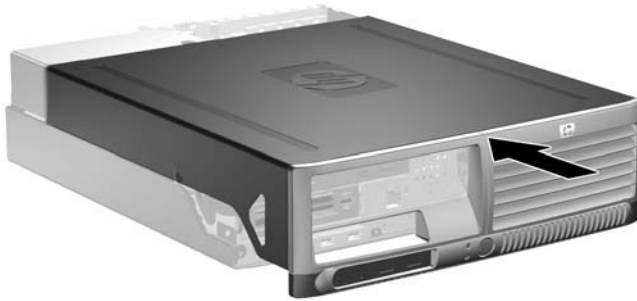
Bild 2-4 Sätta på datorns kåpa igen
