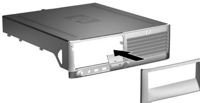
Bild 2-30 Installera en drivenhets panel (hårddiskens panelskydd visas)
