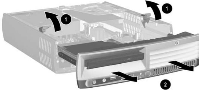
**Figura 2-5** Extracción del panel frontal
