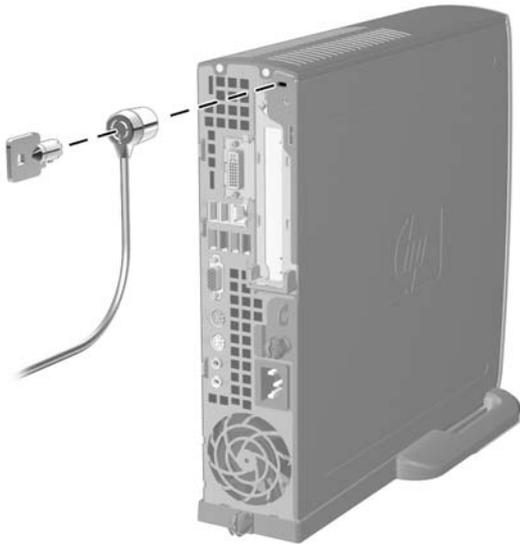
**Figura C-1** Instalación de un candado con cadena
