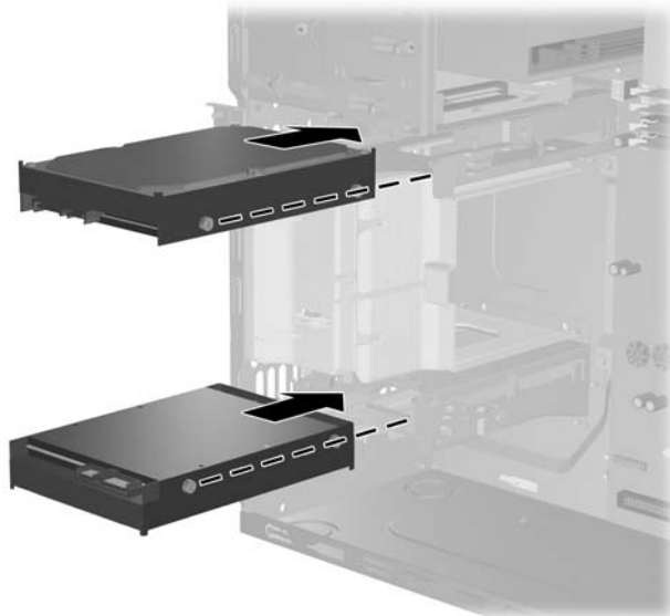
Figura 2-27 Encaixar uma unidade de disco rígido no compartimento
