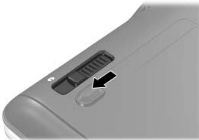
3. 從光碟機插槽取出光碟機。
