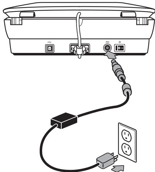
La fuente de alimentación también tiene un cable de CA conectado a la fuente de alimentación en uno de sus extremos. El otro extremo está conectado a una toma de corriente o protector de sobretensión.
