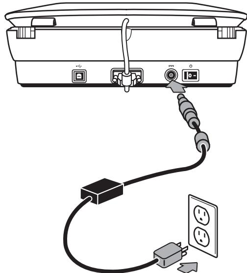
Un câble secteur est également connecté au cordon d'alimentation à une extrémité et branché sur une prise électrique ou sur un parasurtenseur à l'autre extrémité.
