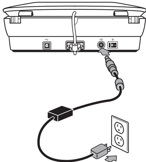
L'alimentatore presenta anche un cavo CA con un'estremità collegata all'alimentatore e l'altra a una presa di alimentazione o stabilizzatore.
