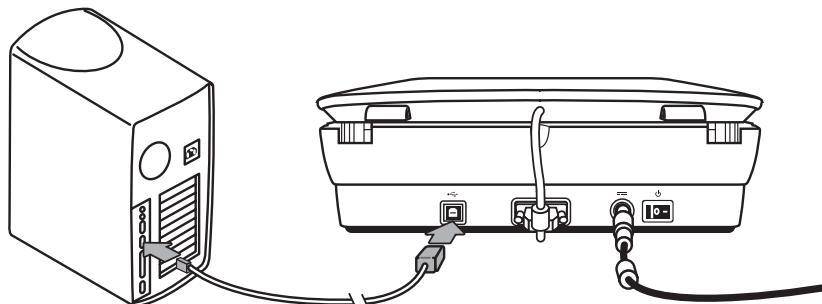
2. Schließen Sie das rechteckige Ende des Kabels an den Computer an.
