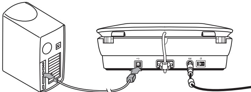
2. Conecte el extremo rectangular del cable al equipo.
