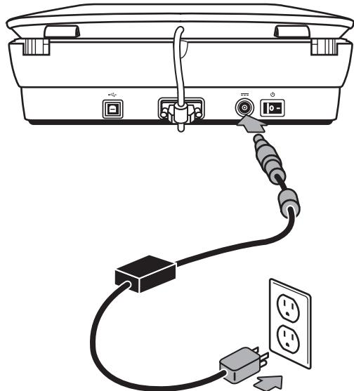
Zum Netzteil gehört außerdem ein Netzkabel, das an das Netzteil und an eine Netzsteckdose oder einen Überspannungsschutz angeschlossen wird.
