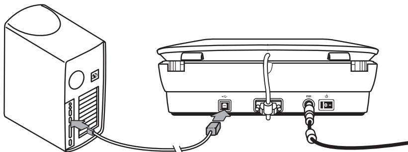
2. Conecte a extremidade retangular do cabo ao computador.
