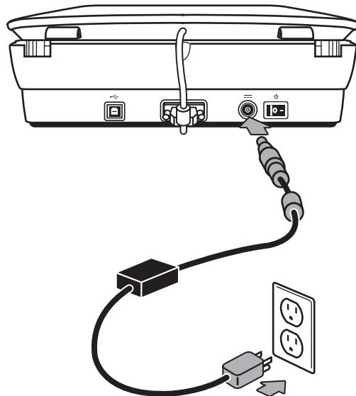
A fonte de alimentação também tem um cabo CA conectado a ela em uma de suas extremidades e conectado a uma tomada elétrica ou a um filtro de linha na outra extremidade.
