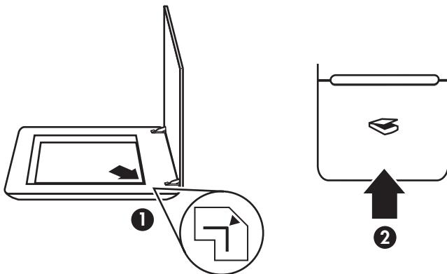
1. Coloque uma foto ou documento no vidro do scanner, como indicado pela marca de referência no scanner.
