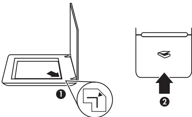
1. Coloque una fotografía o documento en el cristal del escáner como indica la marca de referencia del escáner.
