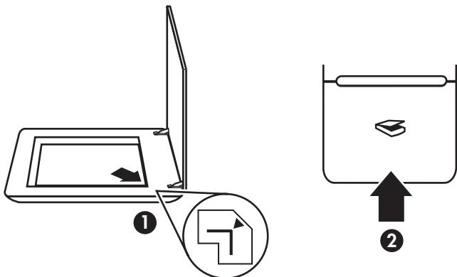
1. Legen Sie ein Foto oder ein Dokument auf das Scannerglas, und richten Sie dieses an der Referenzmarkierung auf dem Scanner aus.
