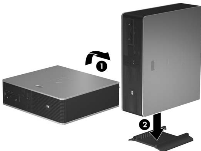
Obrázek 2-1 Změna orientace stolního počítače na typ tower
