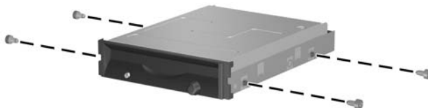
Obrázek 2-27 Instalace vodících šroubů do disketové jednotky
