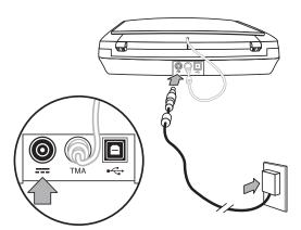
Catu daya ini pun dilengkapi kabel AC yang satu ujungnya dihubungkan ke catu daya dan ujung satunya lagi dicolokkan ke stopkontak listrik atau pelindung arus lonjakan.
