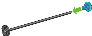
3. Si el diámetro del cilindro interior del rollo es de 7,62 cm (3 pulg.), compruebe que se han instalado los adaptadores de cilindros suministrados con la impresora.
