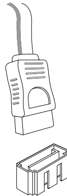
Conector Serial ATA de la placa madre
