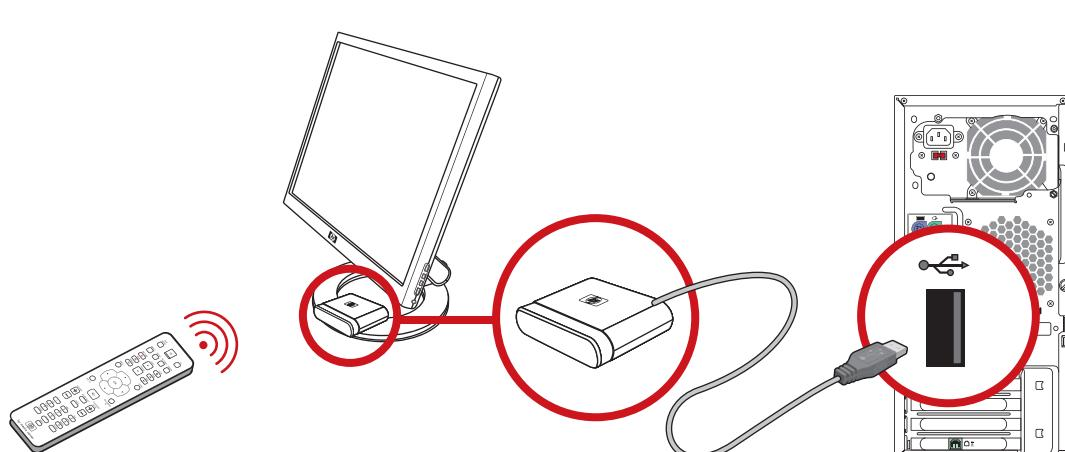
**Si usa un decodificador de cable o de satélite**, pase la señal a través del sensor remoto.
