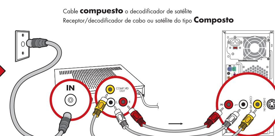
**Si usa un decodificador de cable o de satélite**, pase la señal a través del decodificador.
