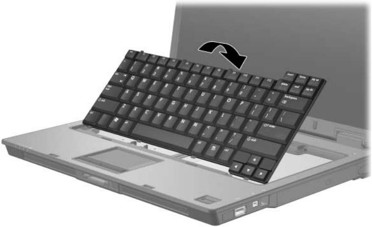
17. Schieben Sie die vier Tastaturverriegelungen zu, um die Tastatur zu verriegeln.
