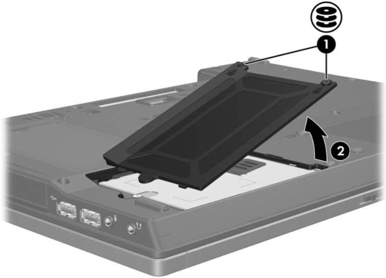
9. Lösen Sie die Sicherungsschraube ❶ für die Festplatte.
