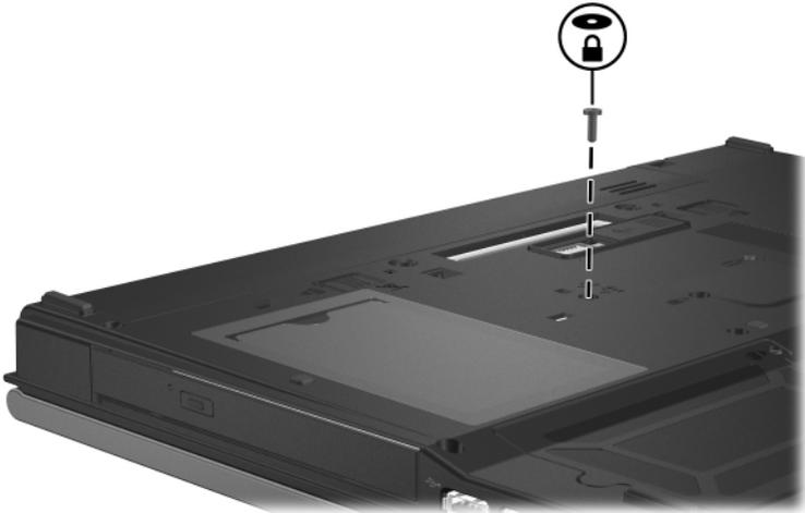
7. Inserire l'estremità di un cacciavite nel foro di rilascio e premere delicatamente fino a sbloccare l'unità ottica.
