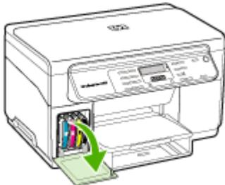
3. Retire los cartuchos de tinta de sus ranuras sujetándolos con los dedos pulgar e índice y tírelos firmemente hacia usted.
