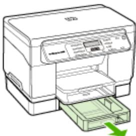
2. Inserte el papel con la cara de impresión hacia abajo, a la derecha de la bandeja. Asegúrese de que la pila de papel se alinee con los bordes del lado derecho y posterior de la bandeja y que no exceda la marca de línea de la bandeja.
