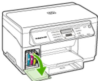
2. Para retirar el cartucho de tinta que debe ser reemplazado, sujételo con los dedos pulgar e índice y jale firmemente hacia usted.
