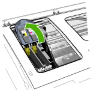
4. Levante el asa del cabezal de impresión (que corresponde al mensaje del panel de control) y úsela para sacar el cabezal de impresión de su ranura.
