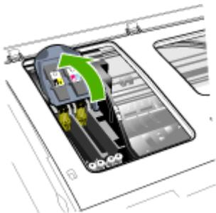
4. Levante el asa del cabezal de impresión y úselo para sacar el cabezal de su ranura.
