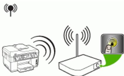
2. Entro due minuti, premere **Imposta**. Se il dispositivo dispone di un display a due righe, selezionare **Rete**, **Installazione guidata wireless** e **SecureEasySetup**, quindi attenersi alle istruzioni visualizzate.
