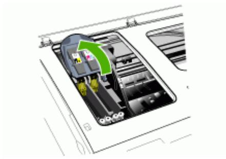
4. Sollevare la levetta della testina di stampa indicata nel messaggio del pannello di controllo e utilizzarla per estrarre la testina di stampa dal relativo alloggiamento.
