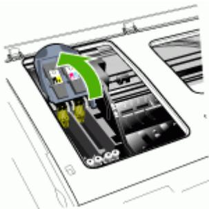
4. コントロールパネルのメッセージに対応するプリントヘッドのハンドルを持ち上げて、プリントヘッドをスロットから引き出します。
