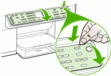
4. コントロールパネルカバーを保管します。コントロールパネルカバーはHP オールインワンと一緒に返送しないでください。
