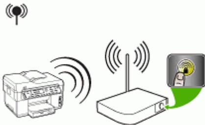
2. 2 分以内に、**[セットアップ]** を押します。2 行ディスプレイのデバイスの場合は、**[ネットワーク]** を選択し、**[ワイヤレス セットアップ ウィザード]** を選択し、**[SecureEasySetup]** を選択して、画面の指示に従います。
