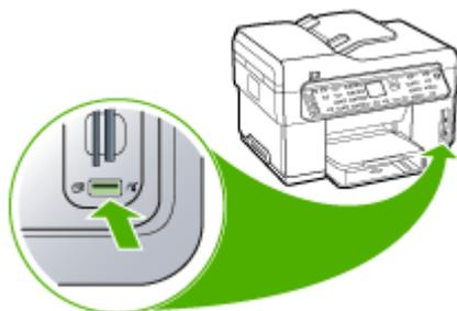
**注記** ストレージ モードに設定されたデジタル カメラは、前面の USB ポートに接続できます。 デバイスはこのモードのカメラを通常のストレージ デバイスとして認識します。 このセクションでは、ストレージ モードのデジタル カメラをストレージ デバイスと呼びます。
