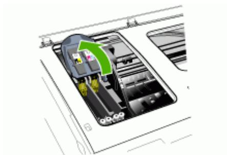
4. プリントヘッドのハンドルを持ち上げて、プリントヘッドをスロットから引き出します。
