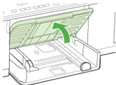
2. 印刷面を下にしてトレイの右端に沿ってメディアを挿入します。メディアの束がトレイの右端と後端に沿い、トレイのラインからはみ出さないよう確認します。
