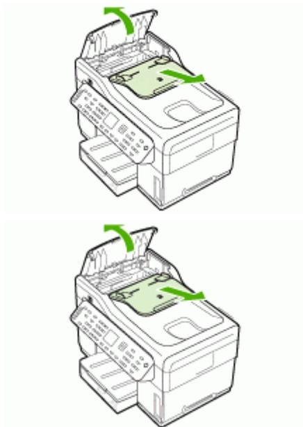
3. メディア詰まり除去部品を取り外します。両手で2つのハンドルを持ち、部品を持ち上げて外します。部品を取り出し、上下を逆にして本体脇に置きます。
