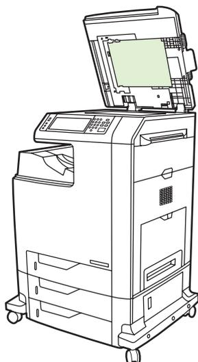
3. Limpe o revestimento do AAD com um pano sem fiapos, limpo e úmido. Use um produto à base de amônia somente quando um pano umedecido em água não for suficiente para limpar os componentes do AAD.
