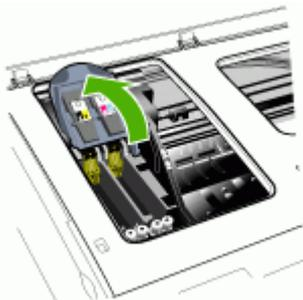
4. Heben Sie den Griff an dem Druckkopf an, den Sie austauschen möchten, und ziehen Sie diesen aus der Halterung.
