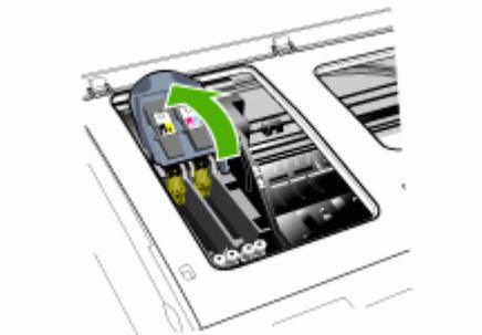
4. Heben Sie den Griff des Druckkopfs an und verwenden Sie ihn, um den Druckkopf aus seinem Schacht zu ziehen.
