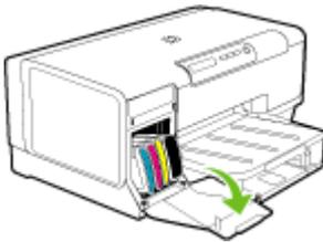
2. Entnehmen Sie die verbrauchte Tintenpatrone, indem Sie sie mit Daumen und Zeigefinger nach oben herausziehen.
