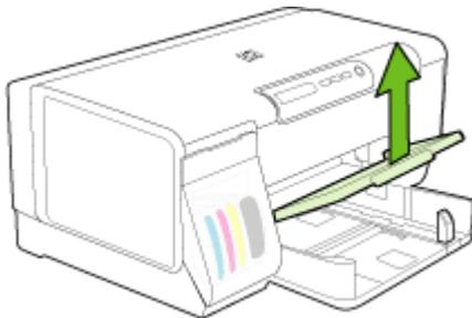
2. Insira a mídia com o lado de impressão voltado para baixo na extensão direita da bandeja. Verifique se a pilha de mídia está alinhada com as extremidades direita e traseira da bandeja e não excede a marcação de linha da bandeja.
