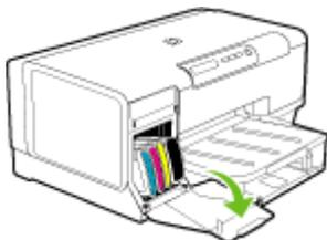
3. Remova os cartuchos de tinta dos slots, segurando-os com o polegar e o indicador e puxando-os com firmeza em sua direção.
