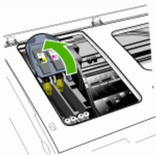
4. Levante a alça do cabeçote de impressão que deseja substituir e retire-o de seu slot.
