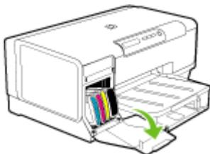
2. Remova o cartucho de tinta que deve ser substituído, segurando-o com o polegar e o indicador e puxando-o com firmeza em sua direção.
