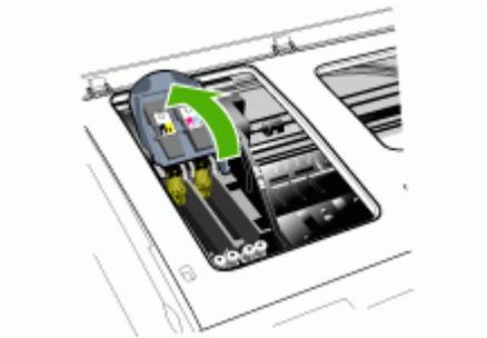
4. Levante a alça do cabeçote de impressão e use-a para puxar o cabeçote para fora do slot.
