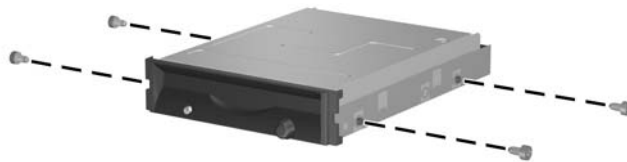
Abbildung 2-27 Installieren von Führungsschrauben am Diskettenlaufwerk
