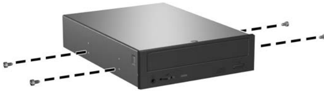
Abbildung 2-21 Installieren von Führungsschrauben am optischen Laufwerk
