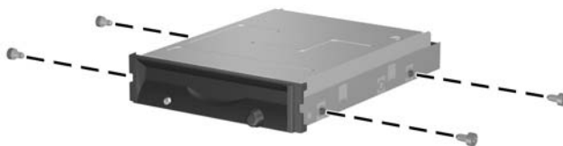
Slika 2-27 Ugradnja vijaka u disketnu jedinicu
