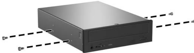
Slika 2-21 Ugradnja vijaka za vođenje u optički pogon
