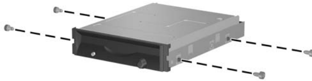
그림 2-27 디스켓 드라이브에 유도 나사 설치
