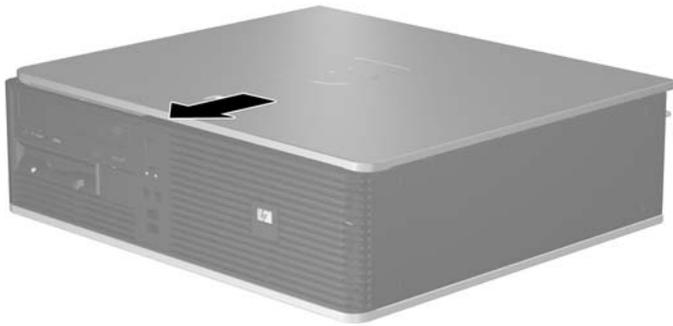
**Figura 2-3** Reemplazo del panel de acceso del equipo
