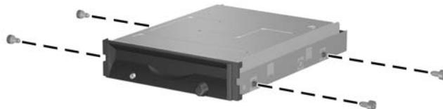
**Figura 2-27** Instalación de tornillos guía en la unidad de disquete
