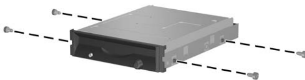
Ilustracija 2-27 Kaip prisukti tvirtinimo varžtus prie diskelių įrenginio
