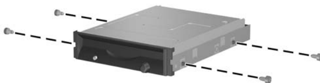
Attēls 2-27 Vadskrūvju ieskrūvēšana diskešu diskdziņī
