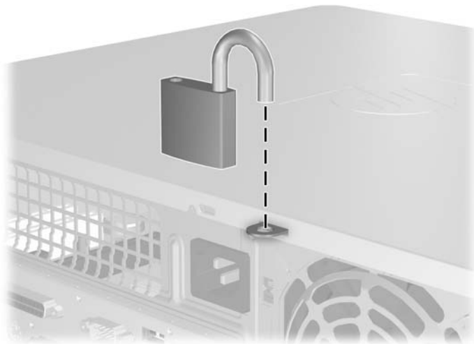
Attēls C-2 Slēdzenes uzstādīšana
