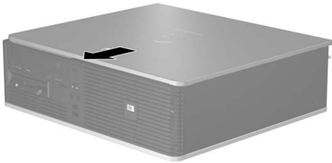
Figur 2-3 Sette tilgangspanelet på plass igjen
