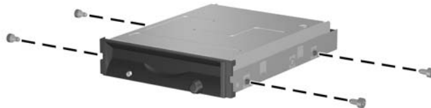
Figur 2-27 Installere styreskruer i diskettstasjonen
