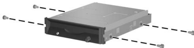
Rysunek 2-27 Instalowanie wkrętów prowadzących w napędzie dyskietek
