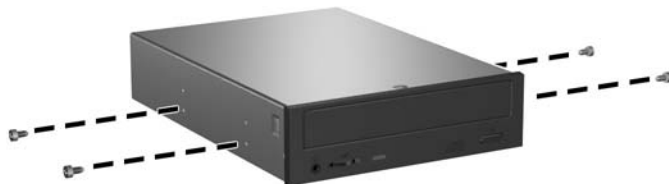
Rysunek 2-21 Instalowanie wkrętów prowadzących w napędzie optycznym
