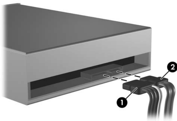
Rysunek 2-19 Odłączanie kabla zasilającego i kabla transferu danych od dysku optycznego
