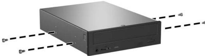
Figura 2-21 Instalar parafusos-guia na unidade óptica
