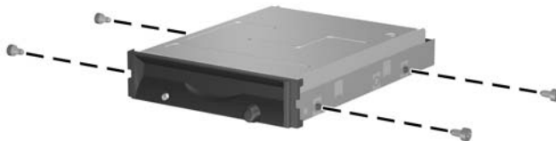
Figura 2-27 Instalar parafusos-guia na unidade de disquetes
