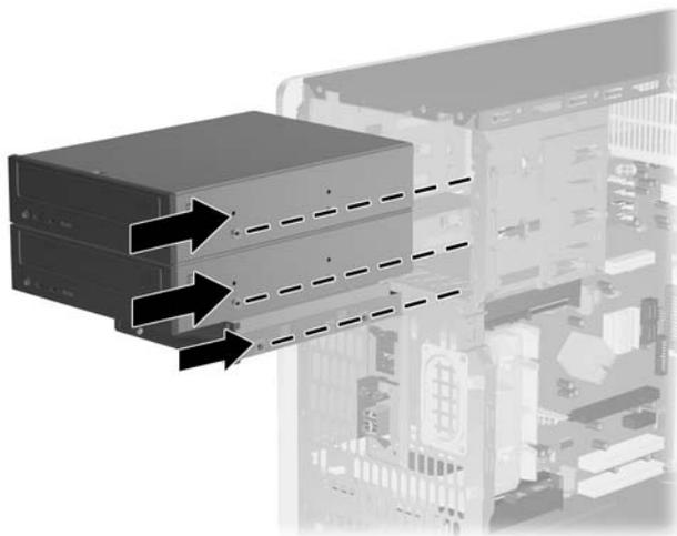
**Figura 2-19** Fazer deslizar as unidades externas para o compartimento
