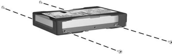
**Figura 2-26** Instalar parafusos-guia da unidade de disco rígido
