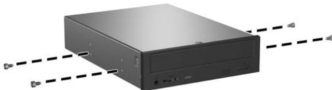
**Figura 2-18** Instalar parafusos-guia (unidade óptica mostrada)
