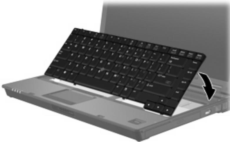
14. Deslice los cuatro pestillos de liberación del teclado para trabar el teclado.
