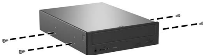
Obrázok 2-21 Inštalácia vodiacich skrutiek do optickej jednotky
