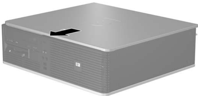
Obrázok 2-3 Založenie prístupového panela počítača
