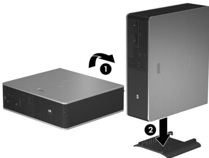
Slika 2-1 Sprememba iz namiznega ohišja v stolp
