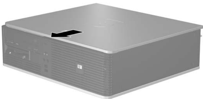
Slika 2-3 Vnovična namestitev pokrova računalnika
