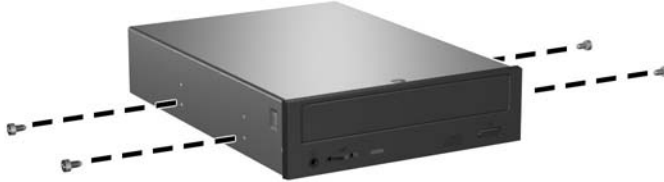
Slika 2-21 Pritrditev vodilnih vijakov na optični pogon
