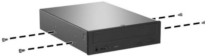
**Figura 2-21** Instalación de tornillos de guía en la unidad óptica
