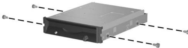
**Figura 2-27** Instalación de tornillos de guía en la unidad de disquete
