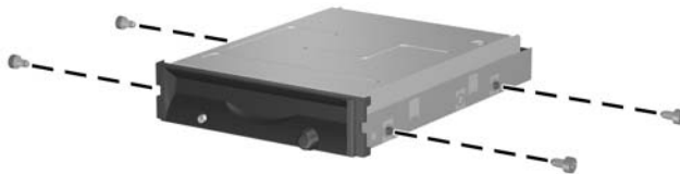
ภาพ 2-27 การติดตั้งสกรูตัวนำในดิสก์เก็ตต์ไดรฟ์
