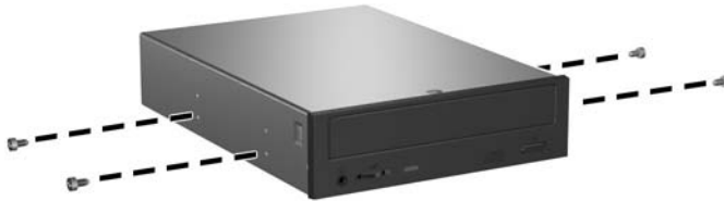
ภาพ 2-21 การติดตั้งสกรูตัวนำในไดรฟ์ถอดออก
