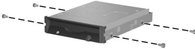
圖示 2-27 將導引螺絲安裝到軟碟機
