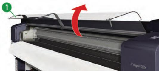
13. Сдвиньте фиксаторы краев носителя (1) к краям валика, чтобы они не были скрыты под бумагой.
