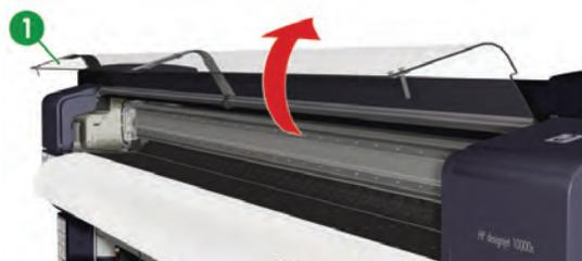
7. Сдвиньте фиксаторы краев носителя (1) к краям валика, чтобы они не были скрыты под бумагой.
