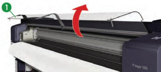
11. Поднимите рычаг загрузки носителя (1).
