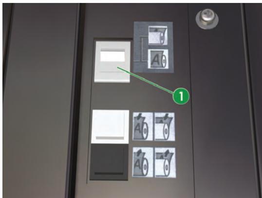
12. С помощью черной кнопки подачи носителя на передней панели принтера продвиньте достаточное количество носителя, чтобы его можно было заправить в устройство автоматической подачи носителя.
