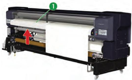
17. Вручную перематйте носитель (1) на дополнительной бобине таким образом, чтобы его край только слегка выдавался из-под задней крышки.
