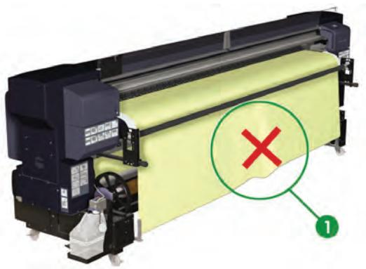
9. Поверните правый фиксатор (2) дополнительной бобины против часовой стрелки, чтобы перемотать прокладочный материал (1) таким образом, чтобы его передний край только слегка выдавался из-под задней крышки.
