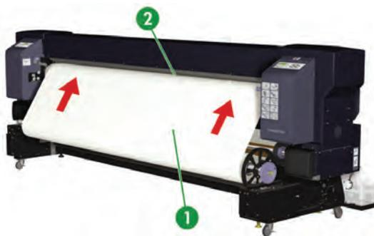
14. Поправьте носитель, чтобы выровнять сделанные ранее отметки (2) с канавкой на валике (1). Если выровнять отметки сразу на обоих концах не удастся, выровняйте сначала одну сторону, а затем выровняйте вторую сторону, удерживая первую в нужном положении.
