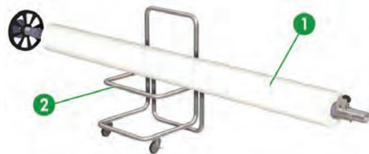
Если установка основной бобины (1) производится двумя сотрудниками без тележки, одному из них придется воспользоваться фиксирующим рычагом (2), чтобы удержать бобину на весу.
