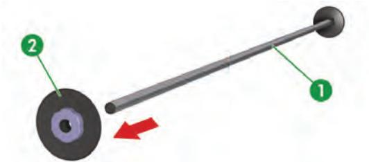
4. Установите на дополнительную бобину (1) фиксатор для печати на двух рулонах (2).
