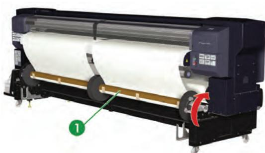
6. Подстройте положение фиксаторов трубки носителя таким образом, чтобы оно соответствовало ширине носителя.
