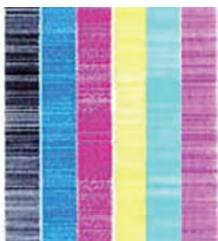
Если все цвета печатаются полосами, необходимо выполнить калибровку принтера для используемого носителя. При выборе предустановленного типа носителя перед сменой параметров рекомендуется создать новый тип носителя (см. раздел [Создание нового типа носителя](#)) и затем выполнить калибровку принтера (см. раздел [Калибровка принтера](#)). Эффект полосатости может проявляться в виде белых линий (как на иллюстрации выше) или темных линий.
