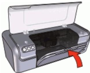
6. Schließen Sie die Abdeckung des Druckers.
