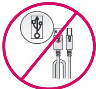
**ПРЕДУПРЕЖДЕНИЕ.** Не подсоединяйте кабель USB до выполнения шага 14, иначе программа может быть установлена неправильно.
