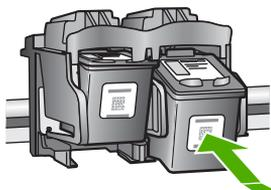
3. Wiederholen Sie die Schritte 1 und 2 für die dreifarbige Druckpatrone im linken Schacht.
