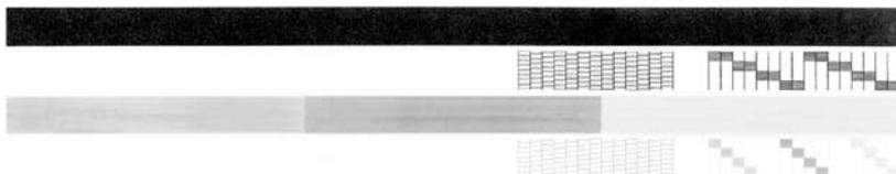
3. Überprüfen Sie, ob die Testmuster ein komplettes Raster anzeigen und die dicken Farblinien durchgehend sind.
