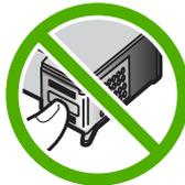
Nehmen Sie die Druckpatronen heraus, und setzen Sie diese wieder ein. Achten Sie darauf, dass sie ganz eingesetzt und fest eingerastet sind.
