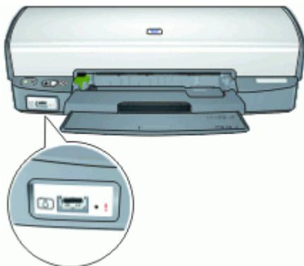
Para poder imprimir fotografías desde el puerto USB delantero es necesario un cable compatible con la cámara. HP recomienda que se utilice un cable de menos de tres metros de longitud.
