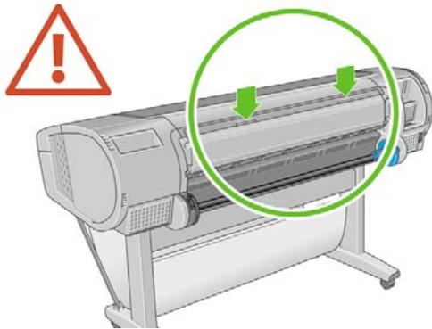
1. スピンドルの右端をプリンタから取り外し、次に左端を取り外します。
