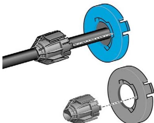
4. ロール紙が長い場合は、スピンドルを台の上に水平に置いて、取り付けるようにしてください。
