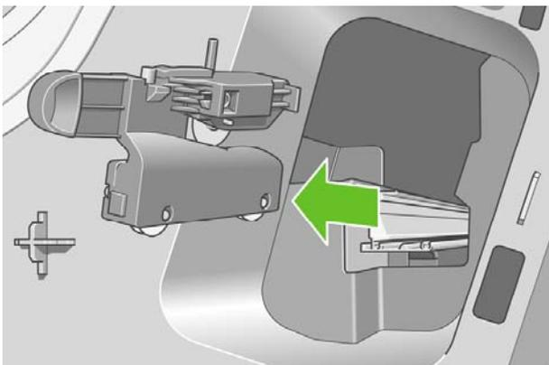
9. 保守キットから新しいカッターを取り出し、上部にあるプランジャーを枠の中でゆっくり前後に動かして、自由に動くことを確認します。
