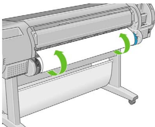
8. 用紙がプリンタに給紙されると、ロール紙またはカット紙のどちらを取り付けるかを尋ねるメッセージがフロントパネルに表示されます。上矢印 および 下矢印 ボタンを使用して[ロール紙]を選択し、OK ボタンを押します。
