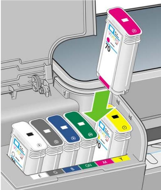
4. 音がして固定されるまでカートリッジをスロットに押し込みます。カートリッジが取り付けられると、ブザーが鳴り、確認メッセージが表示されます。
