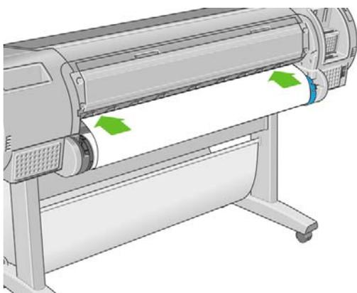
7. スピンドルをフィーダの方向に回します。プリンタが用紙を検出して、用紙をプリンタに自動的に給紙します。
