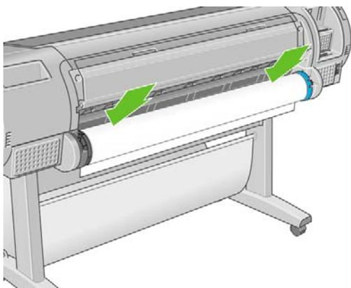
5. ロール紙の端が切れている場合（ロール紙の端を固定するためのテープが原因で起こる場合があります）、または水平にならない場合は、用紙をカット用の溝からカットする分だけ送り、カッターを使用して水平に端をカットします。
