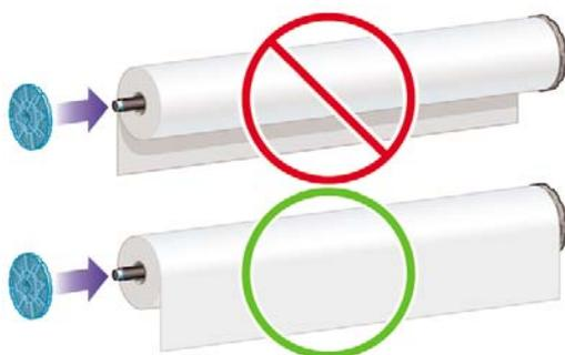
ロール紙の両端とスピンドルのストッパの間には、できるだけ隙間がないようにしてください。
