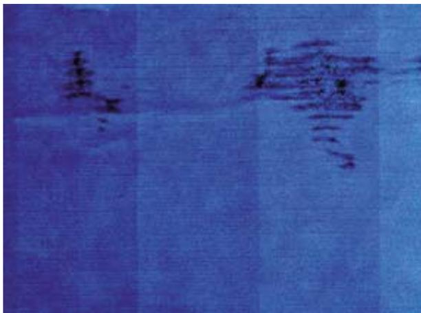
この問題に気付いたら、直ちに印刷ジョブをキャンセルしてください。キャンセル ボタンを押して、コンピュータ アプリケーションのジョブをキャンセルします。インクが付着した用紙によってプリントヘッドが破損することがあります。
