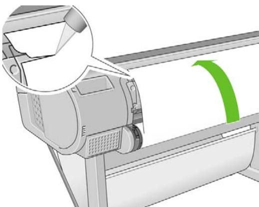
**△ 注意：** 水平でないとう紙を正しく取り付けることができないため、用紙をできるだけ直線にカットします。
