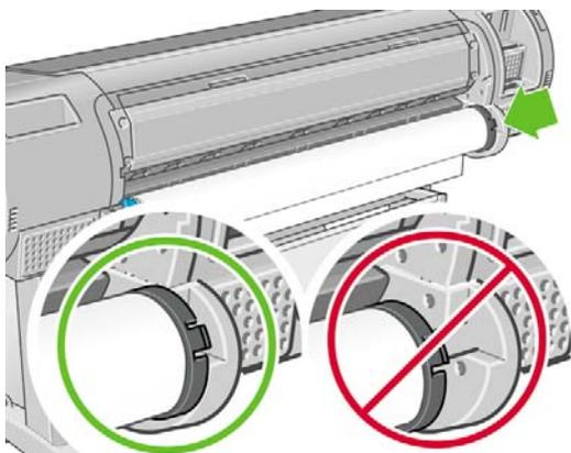
4. 両手を使って、両端のロール紙ホルダーに同時に押し込みます。スピンドルは所定の位置にぴったりはまります。
