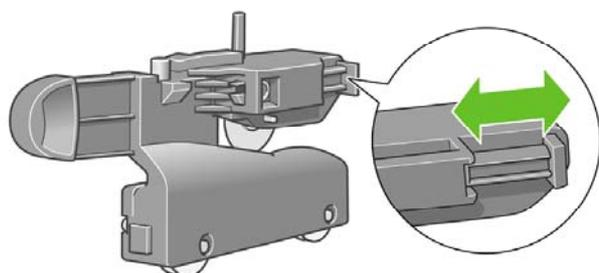
10. 新しいカッターをカッター レールの所定の位置に差し込みます。
