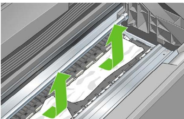
6. プリンタの後ろ側に立ち、ロール紙を巻き戻すか、プリンタからカット紙を引き出します。用紙が見えない場合は、プリンタの前に戻り、排紙トレイから用紙を取り除きます。
