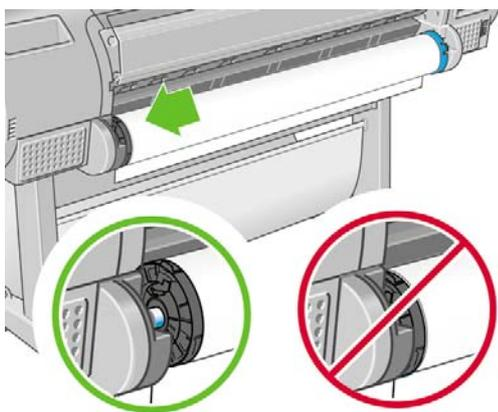
3. 右側のロール紙ホルダーにスピンドルの青い端を載せます。グレーのスピンドルを取り付ける場合は、スピンドルの上端の丸みのある側をロール紙ホルダーに置いてください。
