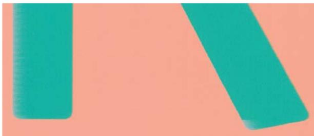
オブジェクトや線画の端がぼやけていたり、はっきり出ていない場合、およびドライバのダイアログ (Mac OSの [プリント] ダイアログ) で印刷品質のスライダをすでに [品質] に設定している場合は、カスタムの印刷品質オプションを選択し、[パスの拡張] オプションと [高精細] オプションがオフになっていることを確認します。[63 ページの「印刷」](#)を参照してください。
