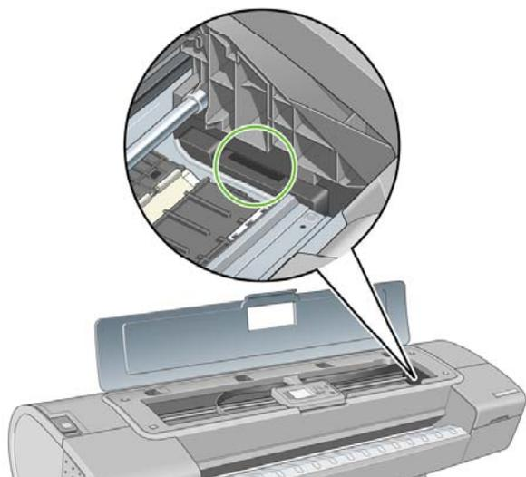
5. プリントヘッド ドロップ検出器に付着しているゴミを取り除きます。
