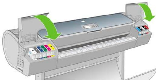
6. フロントパネルに、すべてのカートリッジが正しく取り付けられたことが表示されたら、フロントパネルの **OK** ボタンを押します。
