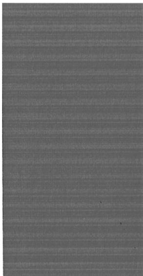
グロスエンハンサ（E）は、透明な液体であるため、単独で印刷した場合には見えません。該当部分が実際に見えるようにするため、イメージ診断の印刷ではグレーのインク（G）の上に印刷されます。
