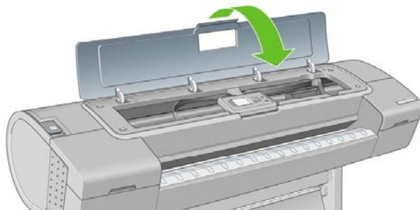
11. フロントパネルに、すべてのプリントヘッドが正しく取り付けられたことが表示されます。プリントヘッドの確認と準備が開始されます。すべてのプリントヘッドを交換した場合、通常の処理はデフォルトで25分ほどかかります。プリントヘッドの準備中に問題が発見された場合、この処理に最大で65分ほどかかることがあります。プリントヘッドを1つだけ取り付けた場合は、20～40分ほどかかります。すべてのプリントヘッドの確認と準備が終了した後、用紙が取り付けられている場合は、プリントヘッドの軸合わせが自動的に実行されます。[254 ページの「プリントヘッドの軸合わせ」](#)を参照してください。
