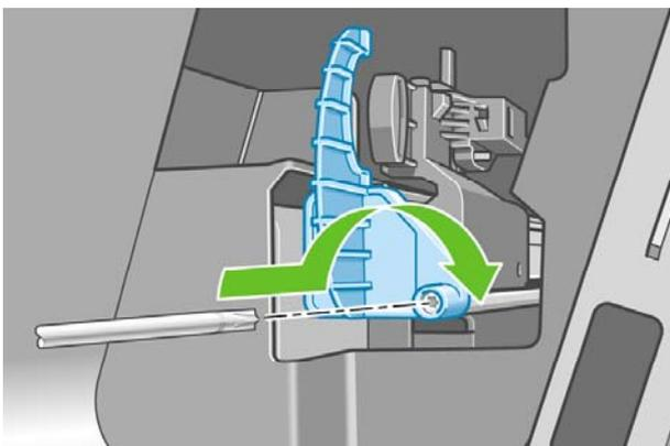
12. 左端のカバーをプリンタに取り付けます。カバー側の突起をプリンタ側の穴に合わせるようにします。
