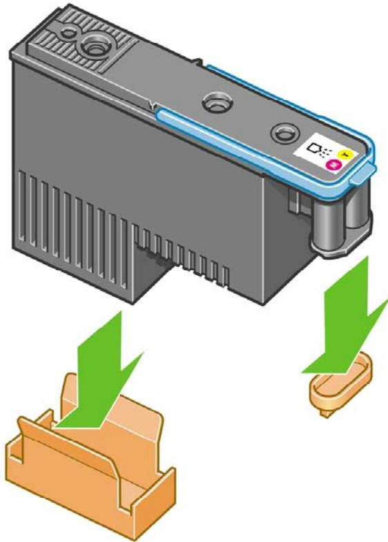
3. プrintヘッドの下部を、同梱の綿棒でクリーニングするか、または綿棒と脱イオン水または蒸留水でクリーニングします。
