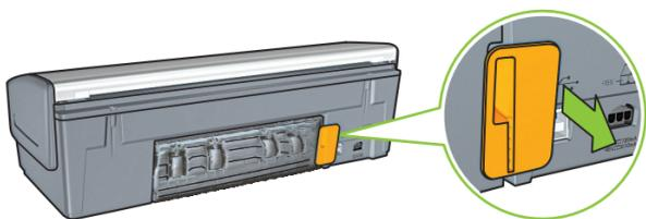
**2** Öffnen Sie die Abdeckung des Druckers, um das orangefarbene Verpackungsmaterial im Inneren zu entfernen.
