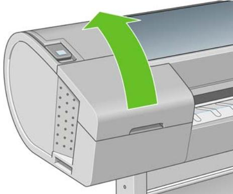
5. Appuyez sur le bouton situé derrière les cartouches d'encre pour dégager le couvercle de l'extrémité gauche de l'imprimante.
