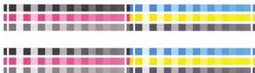
2. Le temps de séchage de la mire de test dépend du type de papier. Il doit permettre aux couleurs de se stabiliser.
