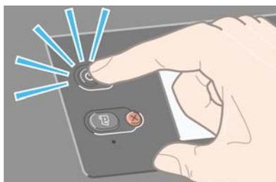
Quando si spegne la stampante in questo modo, le testine di stampa vengono automaticamente riposizionate insieme alla cartuccia di manutenzione, per impedire che si asciughino.
