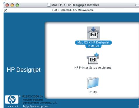
4. Doppelklicken Sie auf das entsprechende Symbol, um das Installationsprogramm zu starten, und folgen Sie den Anleitungen auf dem Bildschirm. Hinweis: Verwenden Sie nach Möglichkeit die Option „**Einfache Installation**“.
