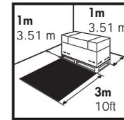
L'espace requis pour l'assemblage est de 3 m (10 pieds) à l'avant de l'imprimante et de 1 m (3,5 pieds) sur les côtés et à l'arrière.
