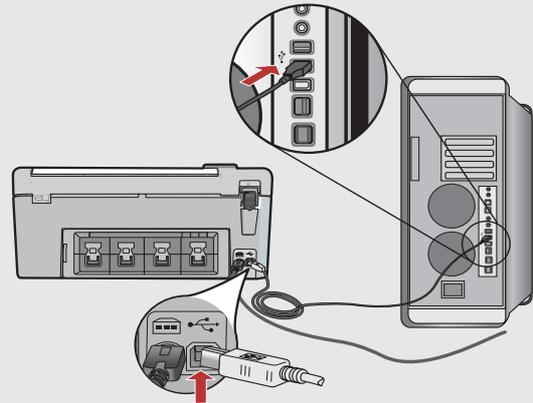
**PL** **WAŻNE:** Jeśli kabel USB nie znajduje się w wyposażeniu, należy go zakupić oddzielnie. **Mac:** Podłącz kabel USB do portu z tyłu urządzenia HP All-in-One, a następnie do dowolnego portu USB w komputerze.
