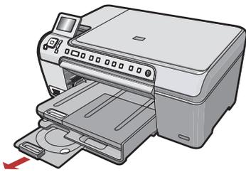
PL Urządzenie HP All-in-One wyposażono w uchwyt i podajnik na dyski CD/DVD, co umożliwia drukowanie na tych dyskach. Więcej informacji na temat bezpośredniego drukowania na umożliwiającym drukowanie dysku CD można znaleźć w Podręcznym przewodniku.
