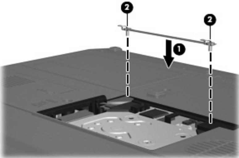
6. 将硬盘驱动器盖上的卡舌 (1) 对准笔记本电脑上的相应槽口。
