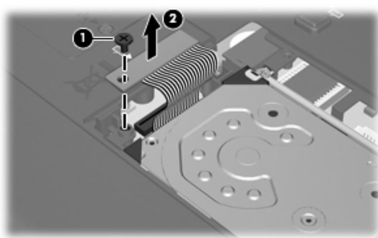
13. 将硬盘驱动器从硬盘驱动器托架中提出。
