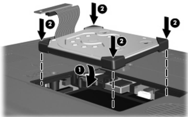
2. 将硬盘驱动器电缆的一端对准硬盘驱动器电缆连接器 (1)，然后轻轻按下，直至硬盘驱动器电缆卡入到位。
