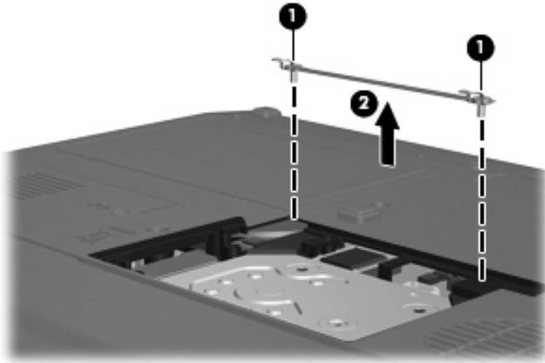
11. 取下硬盘驱动器电缆连接器的螺钉 (1)。
